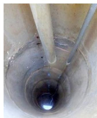
Circulation de la corde avec des bouchons plastique dans un tube PVC (actionnée par une manivelle)
