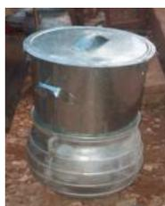
Marmite perforée et adaptée au bac d'étuvage. Au Ghana à droite.
