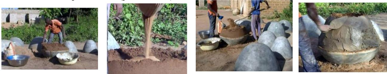
Du sable mouillé est utilisé pour monter la paroi
