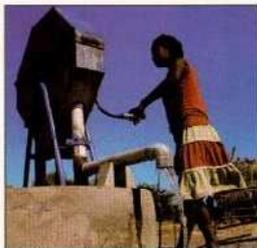
Rope Pump équipé en puits (DpS-Eau)
